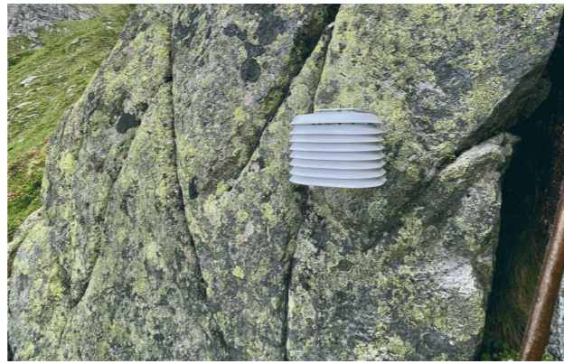
Abb. (3) Mobile Wetterstationen werden eingesetzt um räumlich und zeitlich (alle zehn Minuten) hochauflösende Informationen zur Lufttemperatur und Luftfeuchtigkeit zu erhalten.
