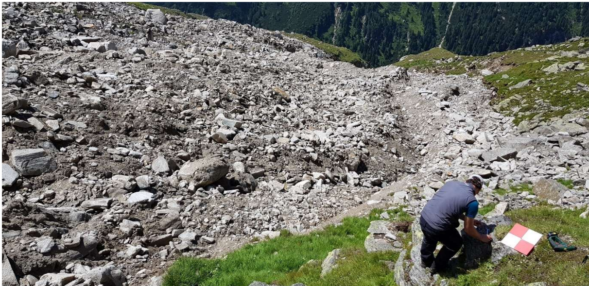
Abbildung 8: Installation von Boden-Kontrollpunkten (12.07.2018).
