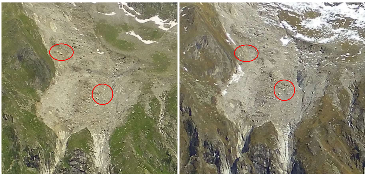
Abbildung 29: Vergleich der Webcam-Bilder zu Beginn und Ende der Sommerperiode 2024 (linkes Bild: 04.07.2024, rechtes Bild: 09.10.2024). Im linken Bild sind Blöcke sichtbar, die während der Sommerperiode bewegt/ausgetragen wurden und daher im rechten Bild nicht mehr sichtbar sind.
