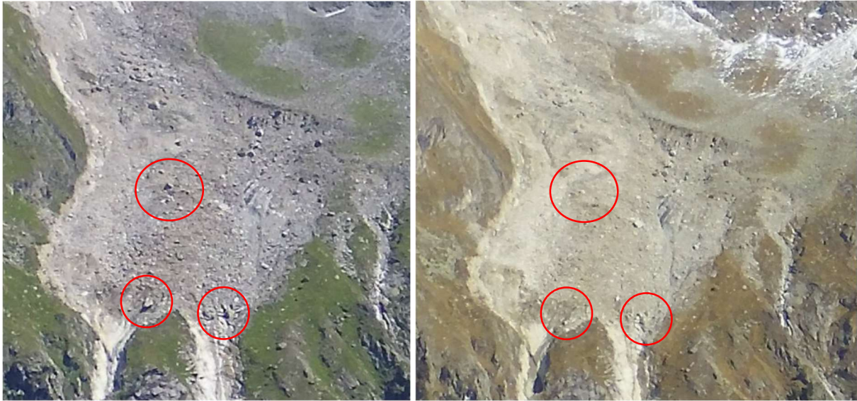
Abbildung 32: Vergleich der Webcam-Bilder zu Beginn und Ende der Sommerperiode 2022 (linkes Bild: 19.07.2022, rechtes Bild: 08.10.2022). Veränderung der Lage von grobblockigem Material, rot markiert.
