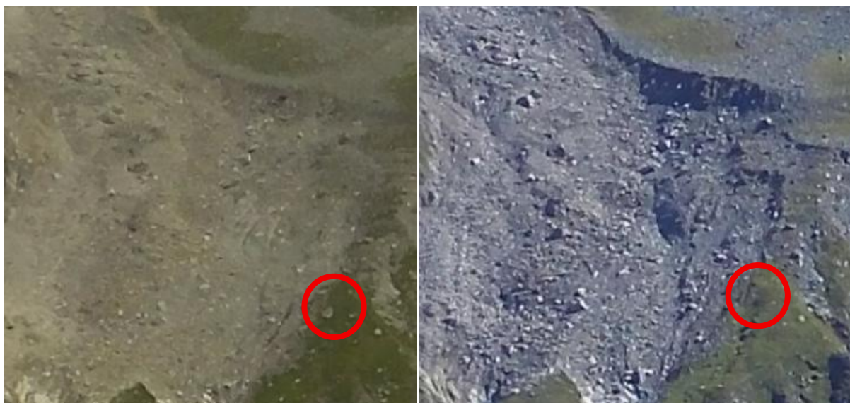
Abbildung 28: Vergleich der Webcam-Bilder vor und nach den starken Niederschlägen am 28./29.08.2025 (Tagesniederschlag Kürsinger Hütte: 56,2 mm, INCA 38,2 mm). Linkes Bild: 27.08.2025, rechtes Bild: 31.08.2025. Im linken Bild sind Blöcke sichtbar, die während der Niederschläge bewegt/ausgetragen wurden und daher im rechten Bild nicht mehr sichtbar sind.
