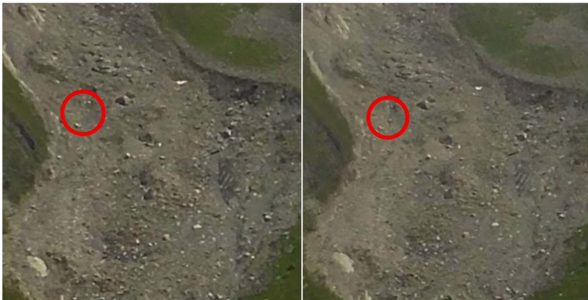
Abbildung 27: Vergleich der Webcam-Bilder vor und nach dem Starkregenereignis am 05.07.2025 (Kürsinger Hütte: Stundenspitze 8,5 mm). Linkes Bild: 04.07.2025, rechtes Bild: 06.07.2025. Im rechten Bild ist zentral im markierten Bereich ein Block sichtbar, der vor dem Ereignis noch nicht an dieser Stelle war.
