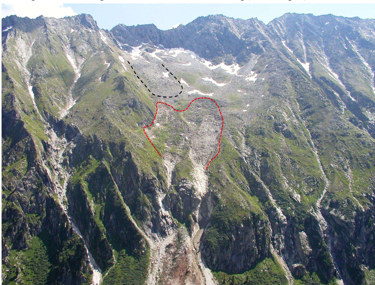
Abbildung 17: Infolge von Starkniederschlägen kam es im Jahr 2005 oberhalb der Trogschulter zur Reaktivierung einer alten Anrisslinie (rote Markierung). In den darauffolgenden Jahren entwickelte sich daraus eine tiefgreifende, rückschreitende Massenbewegung, die schließlich auch den Blockgletscher im oberen Karbereich vollständig erfasste (schwarze Markierung) (Foto: Landesgeologie Salzburg, 03.07.2006).
