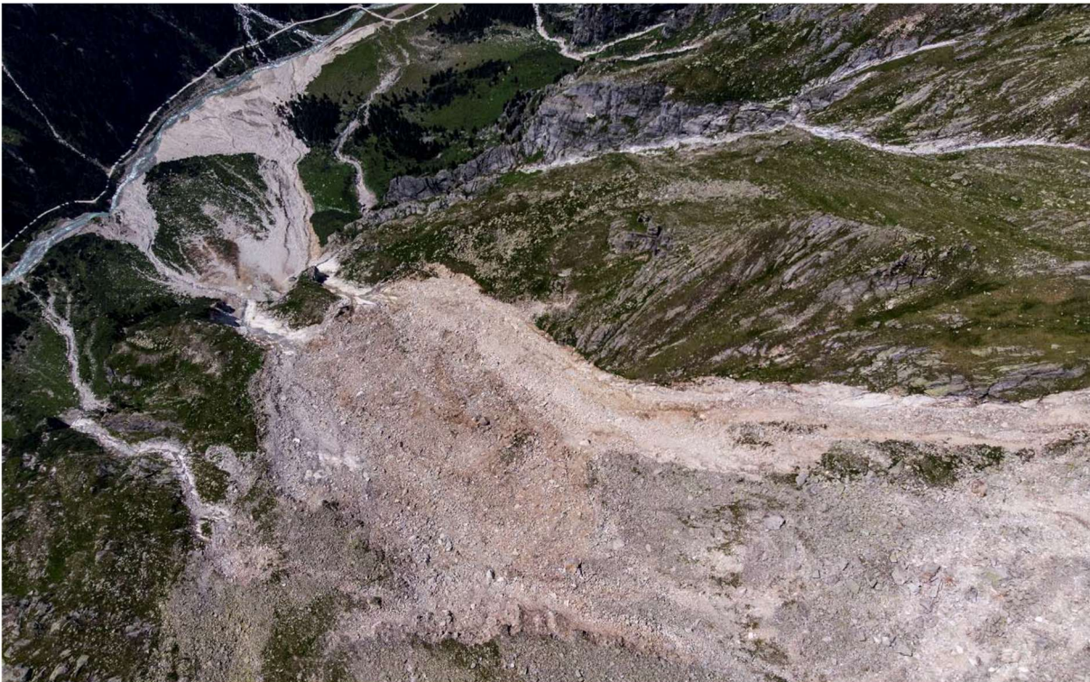
Abbildung 4: Unterer Bereich des Sattelkars. Deutlich zu sehen ist die scharfe, durch Vegetationsbewuchs gekennzeichnete Grenze zwischen aktiven und inaktiven Bereichen an der orographisch rechten (nördlichen) Seite der Rutschung (25.07.2019).
