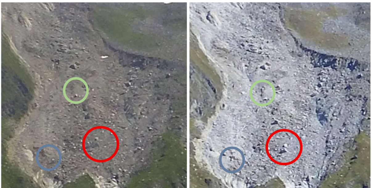
Abbildung 29: Webcam-Vergleich vor und nach der sommerlichen Niederschlagsperiode: linkes Bild 01.07.2025, rechtes Bild: 20.09.2025. In den drei markierten Bereichen sind grobblockige Ablagerungen erkennbar, die zu Beginn der Niederschlagsperiode noch nicht vorhanden waren.
