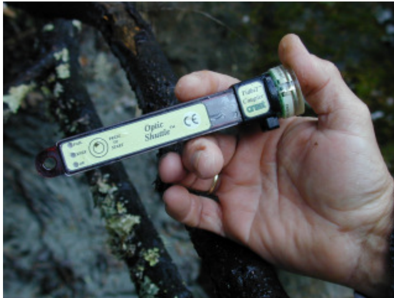
Foto 3: Infrarottransfer der Daten vom Logger in den Optic Shuttle
