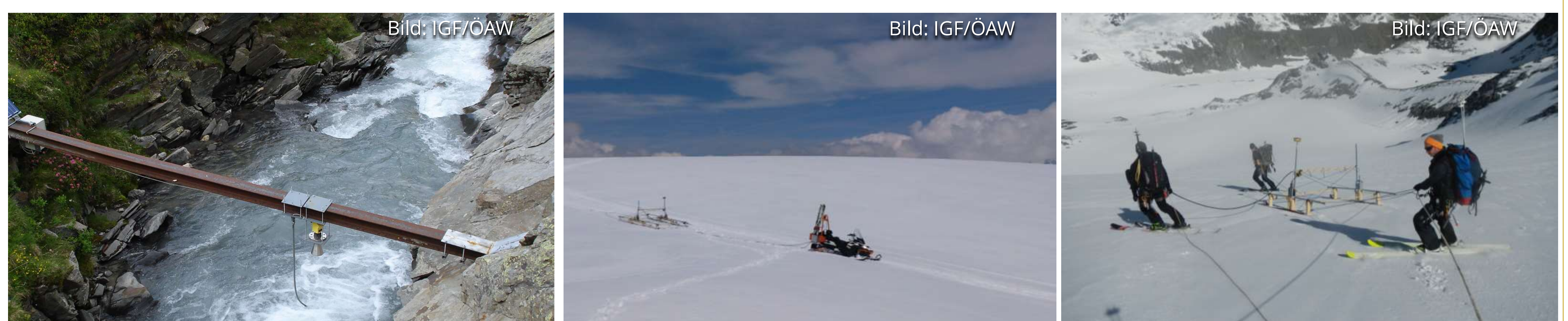
Hydrologische Methode: Abflussmessungen (links) Eisdickenmessungen mittels Radar (Mitte und rechts)
