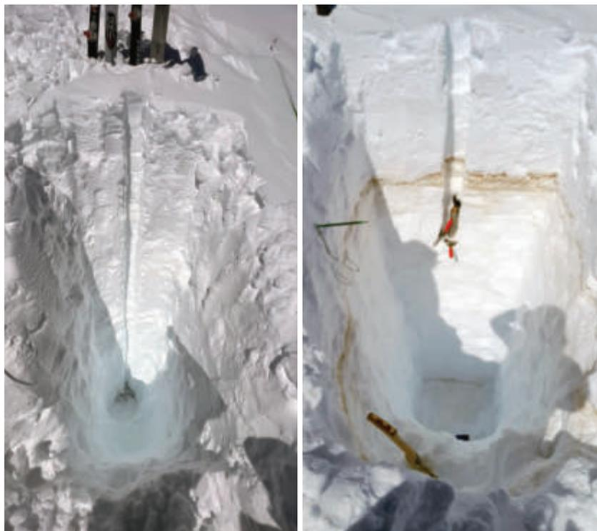
Abbildung 2: Frühjahrsschacht 1 (links, Foto A. Gschwentner) und Frühjahrsschacht 2 (rechts) mit ausgeprägter Saharastaubschicht am 28.04.2022. Ende August 2022 waren die Rücklagen bereits vollständig abgeschmolzen.
