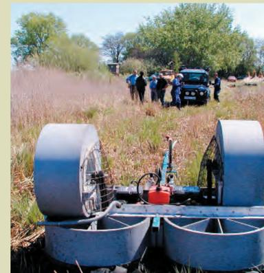
Eine Möglichkeit der effizienten Altschilfernte bestünde im Einsatz von Luftkissenfahrzeugen – wie bereits 2002 anhand eines Modellversuchs gezeigt wurde
