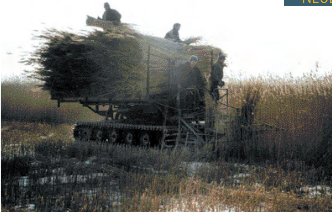
„Schilfraupen“ – Geländegängige Fahrzeuge zum Schilfschneiden.
