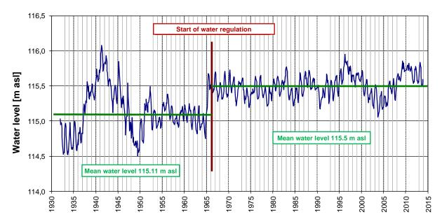
Figure 14. Hydrograph of the lake water levels 1932–2013. Source: Amt der Bgld. Landesregierung, Referat Hydrographie.
