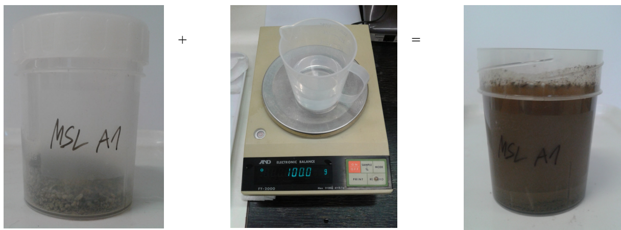
Abb. 4: Erstellung eines Wasserauszugs im Verhältnis 1:5 (hier: 20 g gesiebter Boden + 100 ml Aqua dest. = Wasserauszug von 120 ml).
