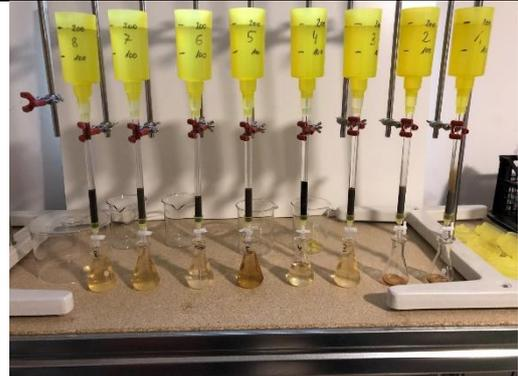
Abb. 13: Experimentelle Anordnung zur Bestimmung der Staufähigkeit des Sediments
