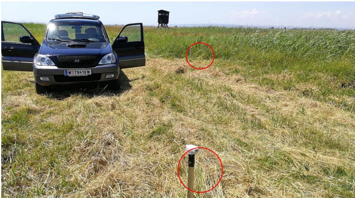
Abb.21: Messstelle für die Messung des Wasserstandes im Anlockbereich und des Grundwasserstandes im Anlockbereich der Östlichen Arbesthaulacke
