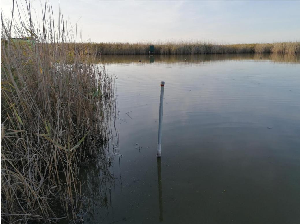
*Abb.16: Messstelle für die Messung des Grundwasserstandes im Anlockbereich der Dorflacke*
