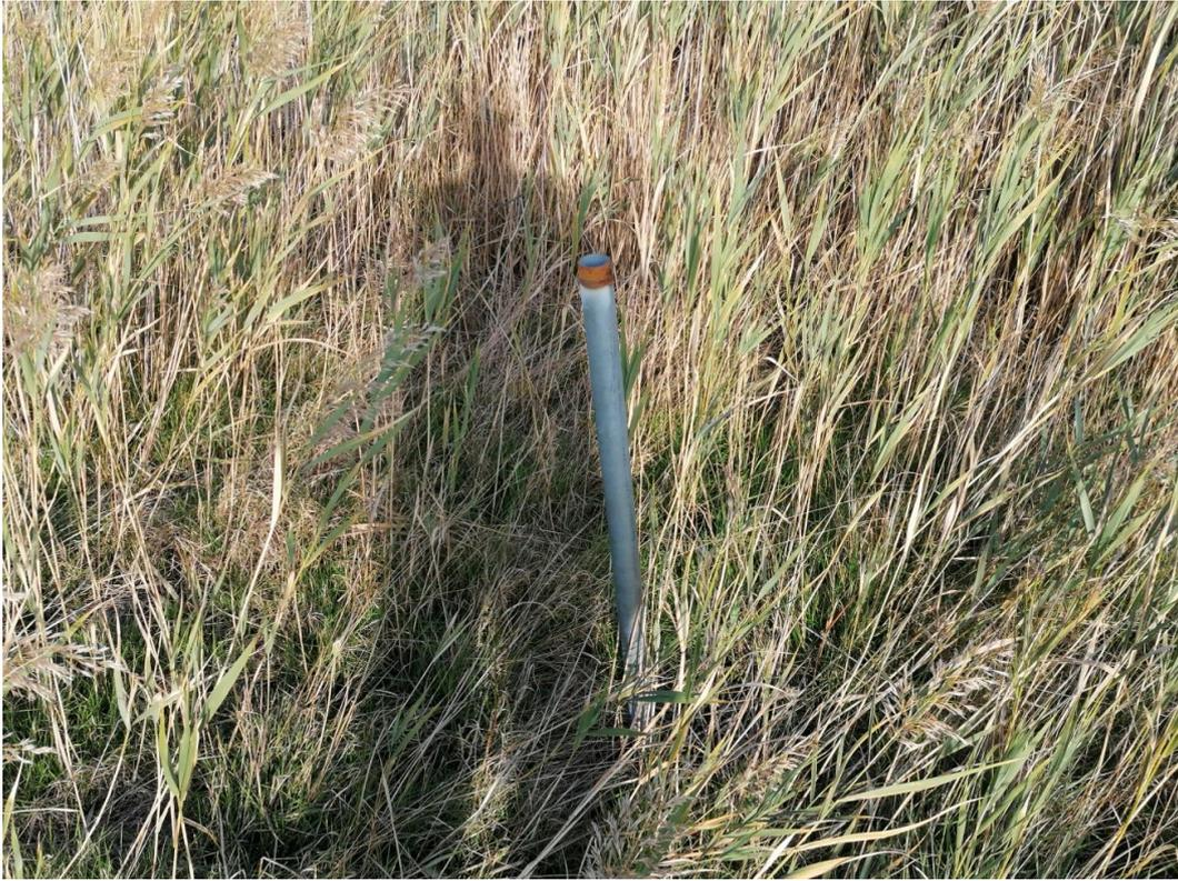
*Abb.11: Messstelle für die Messung des Grundwasserstandes außerhalb des Anlockbereiches der Moschatolacke*
