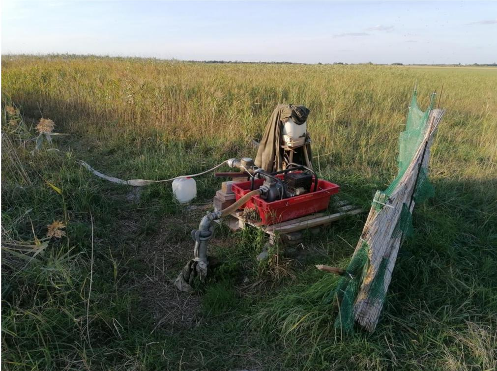
*Abb.18: Pumpanlage mit Wasserzähler zur Erfassung der gepumpten Mengen in die Dorflacke*
