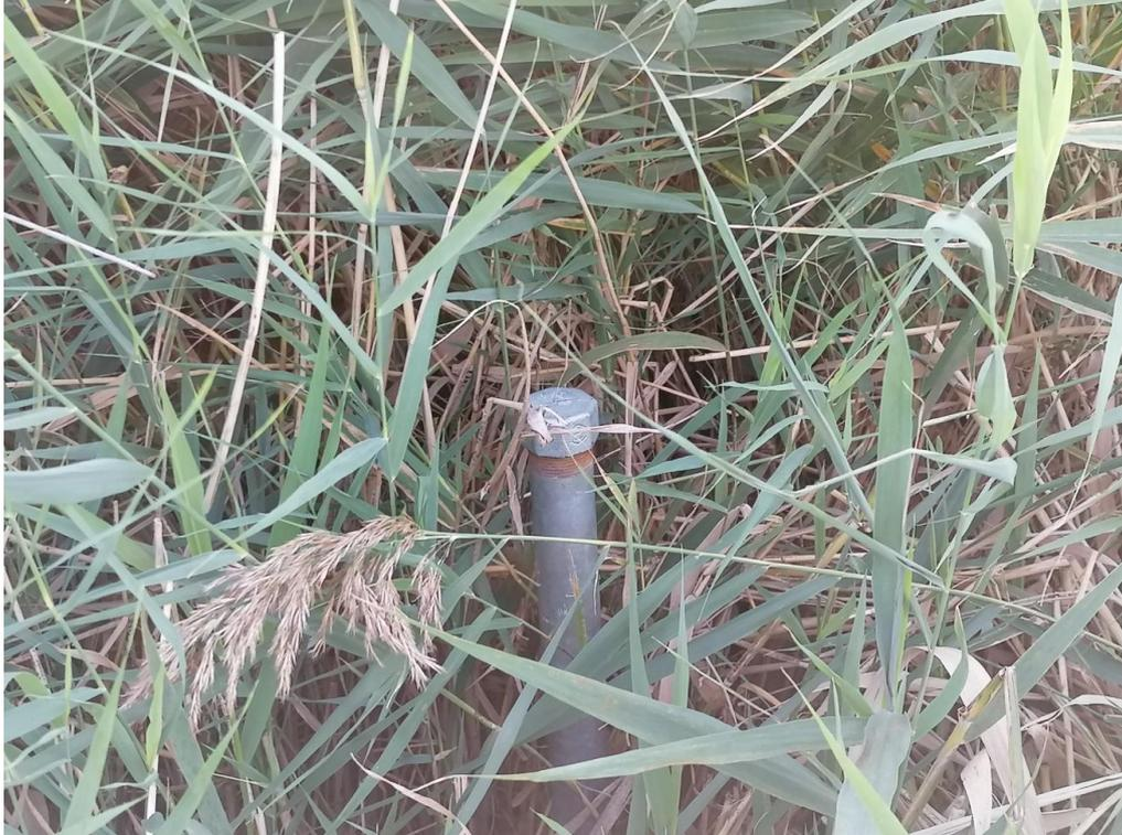
*Abb.5: Messstelle 2 für die Messung des Grundwasserstandes im Anlockbereich der Götschlacke*
