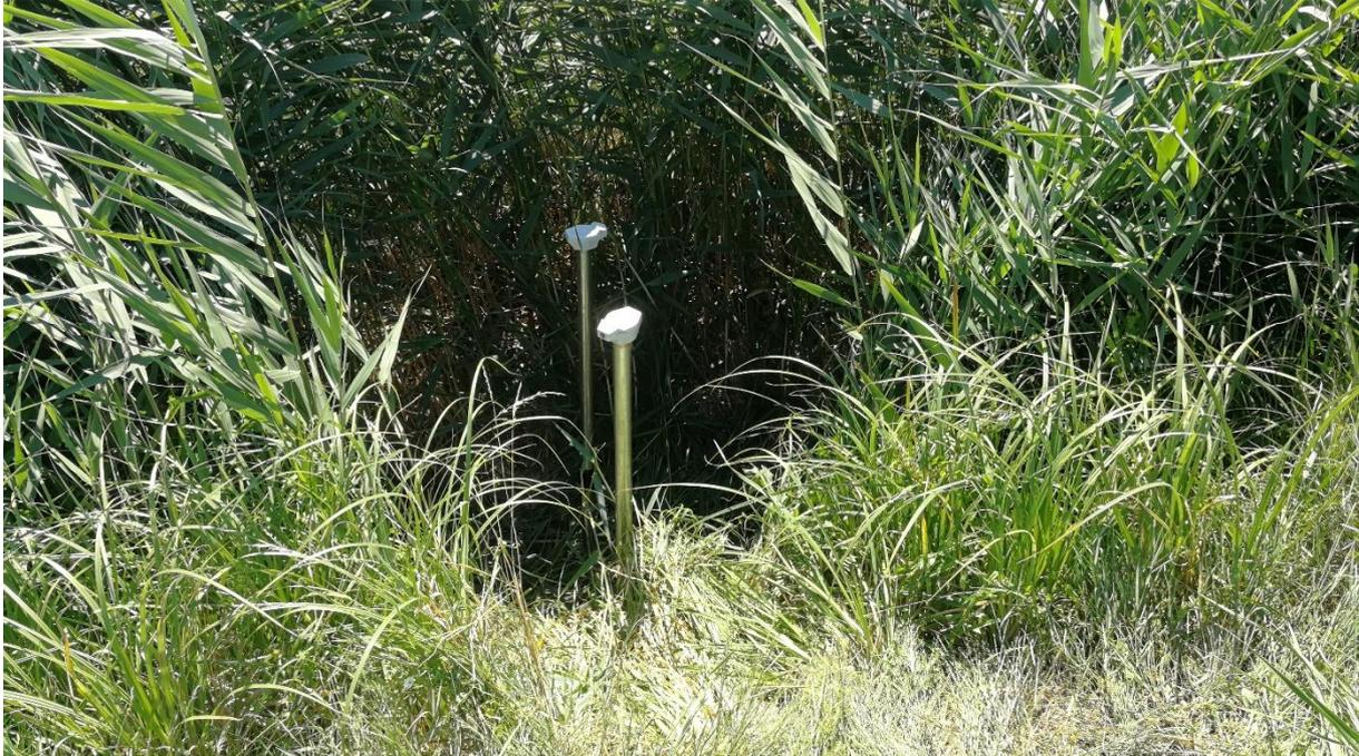
Abb.22: Messstelle 13 und 14: zur Messung des Wasserstandes im Verbindungsgraben zwischen der Östlichen Arbesthaulacke und dem Seewinkler Hauptkanal und des Grundwasserstandes unter dem Graben
