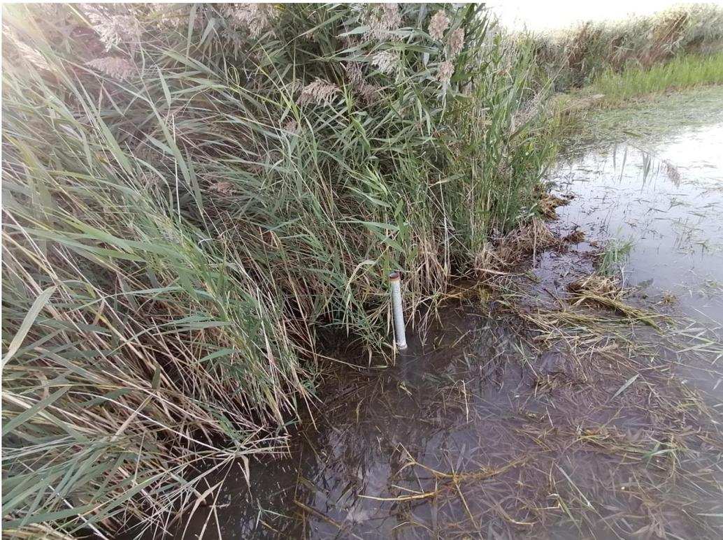
*Abb.10: Messstelle für die Messung des Grundwasserstandes im Anlockbereich der Moschatolacke*
