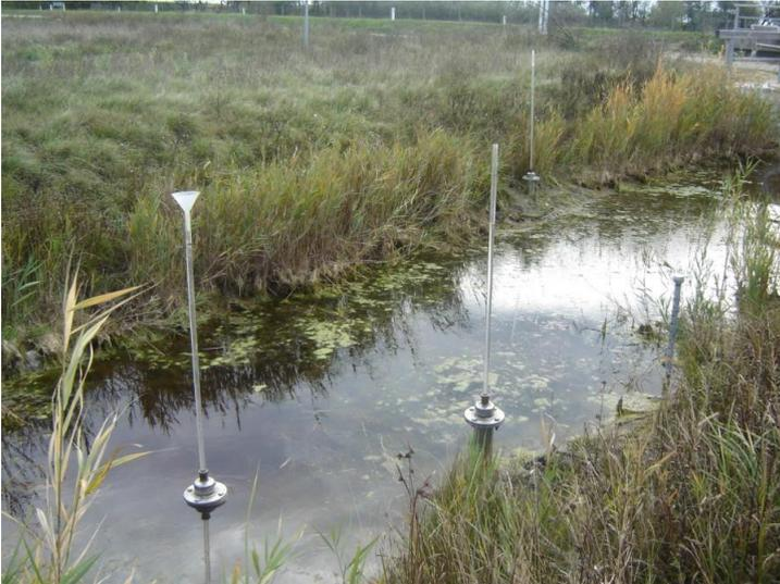
Abb.23: Beispiel eines Sickersversuches in einem Graben zur Feststellung der Sohldurchlässigkeit
