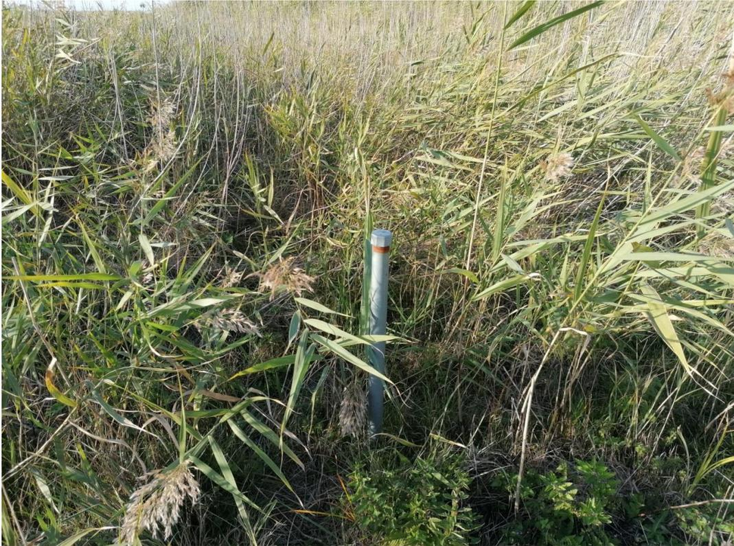
*Abb.6: Messstelle für die Messung des Grundwasserstandes außerhalb des Anlockbereiches der Götschlacke*
