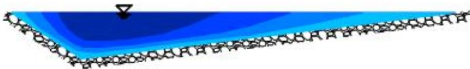
Abbildung 15: Fließgeschwindigkeitsverteilung in einem stark asymmetrischen Profil; hellblau –geringe Fließgeschwindigkeit, dunkelblau – hohe Fließgeschwindigkeit
