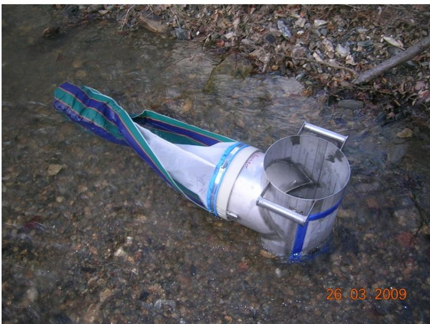
Abb. 26: Hess – Sampler.
