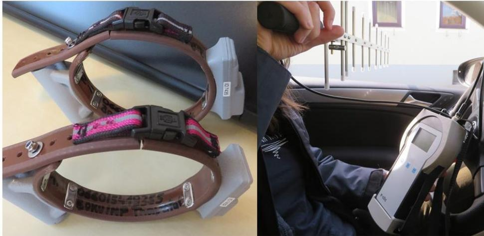
*Abb. 2: Links zwei der acht GPS-Halsbänder mit den zusätzlich eingenähten Sicherheitsverschlüssen der Marke Trixie. Rechts das Auslesen der Daten mit der e-obs BaseStation und der Yagi-Antenne vor dem Haus der Katzenbesitzer\*innen. (Fotos: Wimmer-Schmidt)*
