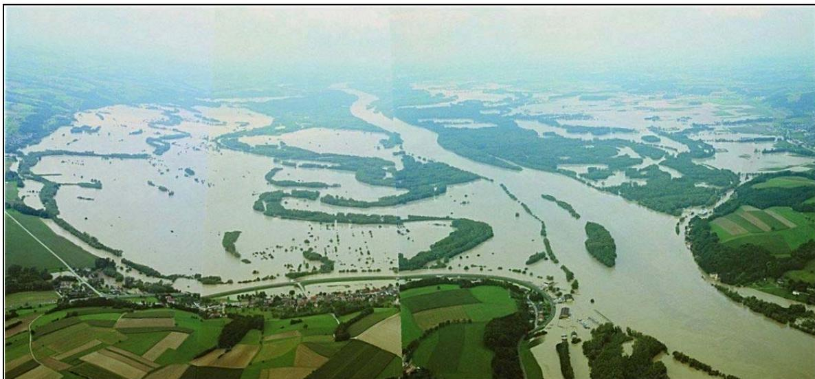
Abbildung 7: Überflutungen im Projektgebiet beim 100-jährlichen Hochwasser 2002; Blick von Ardagger flussauf Richtung Wallsee; im Vordergrund: enge Talpforte des Strudengaus (Dornacher Enge); Bildmitte: die schmalen Auwaldstreifen zeigen den Verlauf des südlichen Hauptstromarmes und eines mäandrierenden Nebenarmes im Jahr 1821 (Karte Nr. 5 im Anhang); vgl. ähnliche Perspektive im Jahr 1812 (siehe Beilage Nr. 27).
