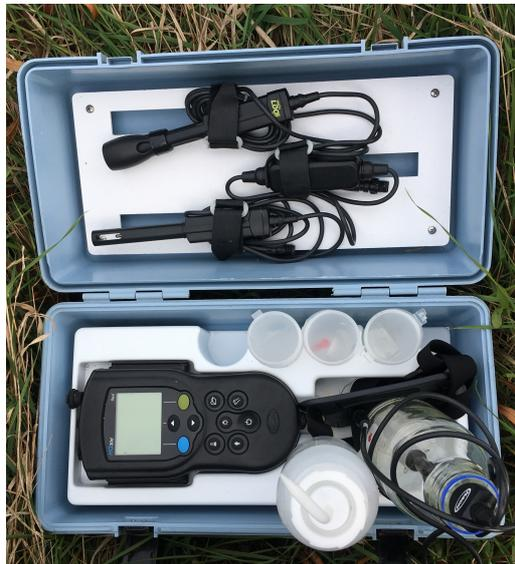
Abb. 26: Der HQ30D Digitalen Multimeter dient zur Erhebung der Gewässerparameter (eigene Aufnahme am 20.10.2018)
