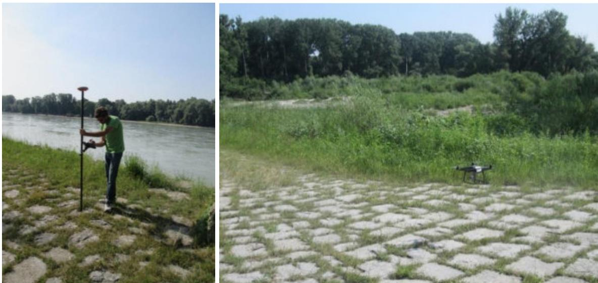
Abbildung 63: Einmessen von Referenzpunkten mittels Differenzial-GPS (links); Start der Drohne DJI Phantom IV (rechts)
