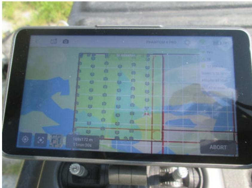
Abbildung 64: Steuerkonsole der Drohne DJI Phantom IV. Das Rote Quadrat stellt einen von 11 Quadranten dar
