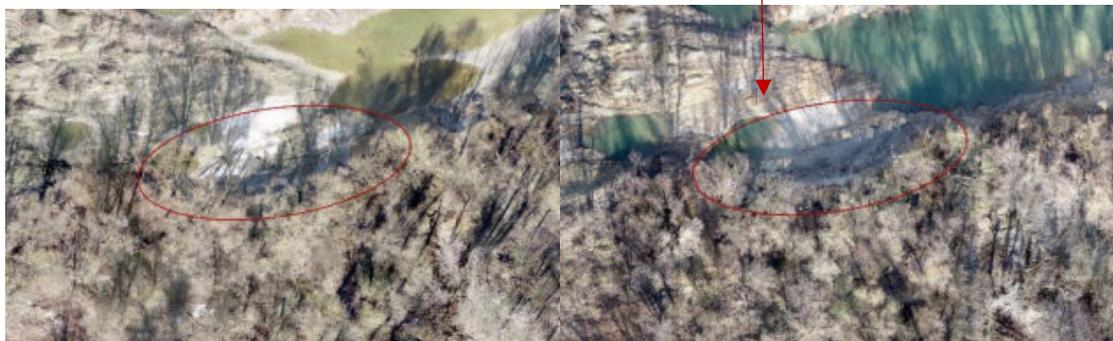
Abbildung 73: Darstellung von ersichtlichen Erosionsprozessen (Ufererosion) am selbst generierten Orthofoto
