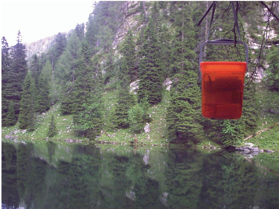
**Abb. 4** Montage der Horchbox an einer exponierten Stelle: die Ultraschallrufe vorbeifliegender Fledermäuse werden automatisch aufgenommen, sobald sie einen Schwellenwert erreichen. Foto: S. Pysarczuk
