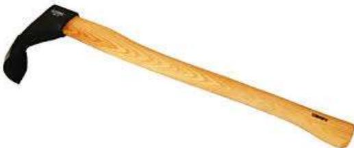
Der Dechsel (Abb. 39) wurde zum Wegnehmen größerer Spanmengen, aber auch zum abschließenden Glätten von Oberflächen benutzt. Bei einem Dechsel steht die Schneide quer zum Stiel, sie ist zwischen 60 und 100 mm lang, verstäht und stets einseitig von innen angeschliffen. Eine besondere Ausführung, Hohldechsel genannt, hat ein in zwei Richtungen gekrümmtes Blatt und eine Schneide wie ein Hohleisen. ([www.fachwerk-kowarsch.de](http://www.fachwerk-kowarsch.de), 06.05.2015)
