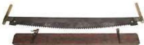
Diese Form der ungespannten Säge ist auch unter der Bezeichnung Bauch-, Baum-, Bogen-, Öhr-, Wald-, oder Zimmermannssäge (Abb. 40) bekannt. Mit der Schrotsäge trennt man sowohl nasses als auch trockenes Holz quer zur Faser. Grundsätzlich wird sie von zwei Mann bedient und hat je nach Verwendungszweck eine besonders angepasste Bezahnung, die immer auf Stoß und Zug wirkt. (www.fachwerk-kowarsch.de, 06.05.2015)
