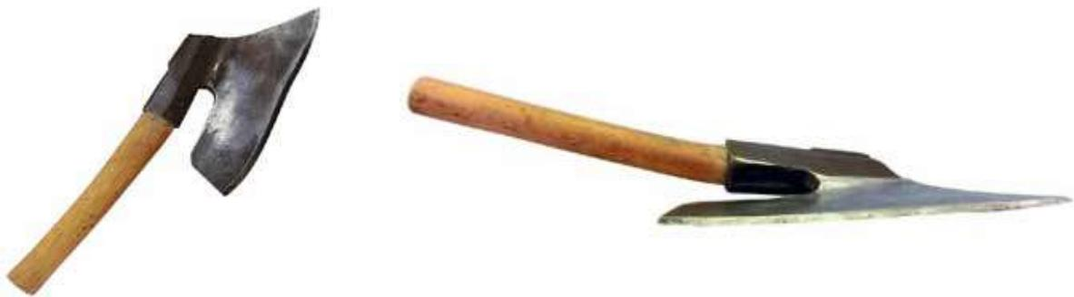
Das Breitbeil (Abb. 37) wird zum behauen von Rundholz verwendet und ist etwa 50 bis 70 cm lang. Es unterscheidet sich von anderen Äxten und Beilen dadurch, dass eine Seite des Kopfes abgeflacht ist und der Stiel schräg zum Kopf läuft. Dabei gibt es rechte und linke Ausführungen.
