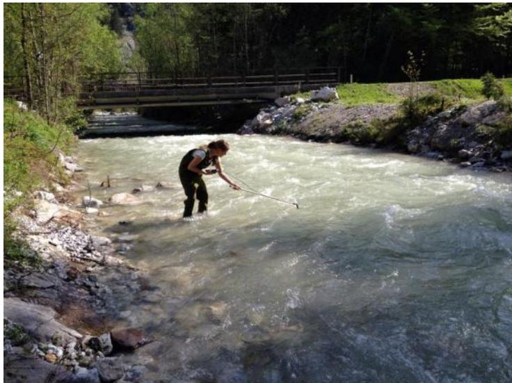
Abb. 6: Messung des Abflusses an der Station BB am 08.05.2015 (Quelle: Andrea Danklmaier).
