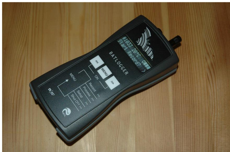
**Abb. 4** Automatische Registriereinheit („Batlogger“, Elekon AG, Luzern). Foto: S. Pysarczuk
