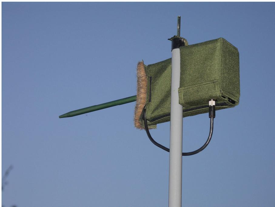
**Abb. 3** Automatische Registriereinheit („Batcorder“, ecoObs, Nürnberg). Foto: G. Reiter
