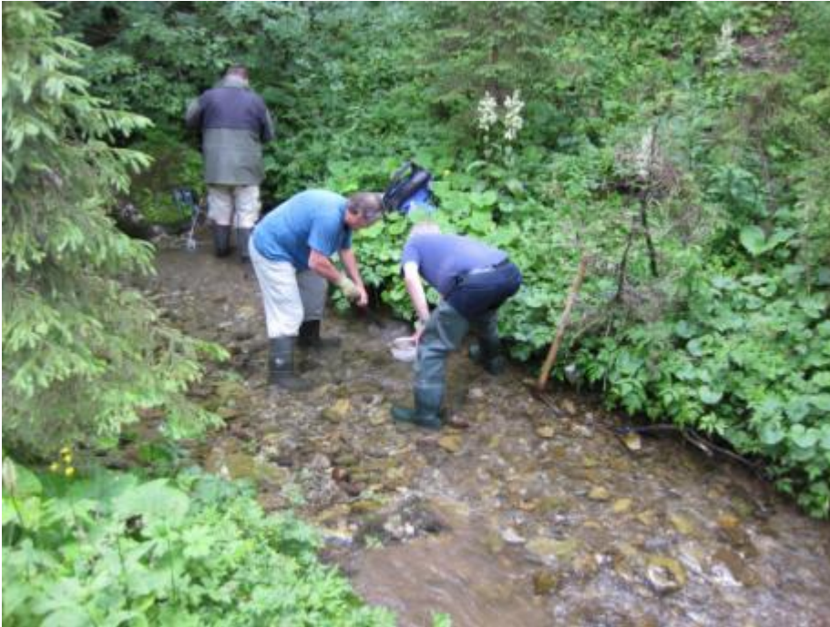
Foto 25: Interstitialgrabung am Schafhüttelbach - mittels Brechstange werden Steine gelockert und angehoben, das darunterliegende Sediment aufgewühlt. - Foto: C. Remschak, 16.07.2018
