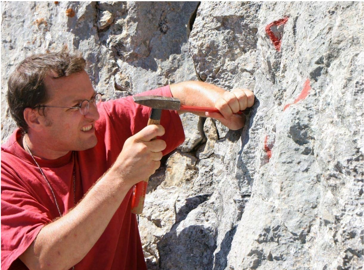
Abb. 111. Aufsammeln der Proben mit Hammer und Meißel.
