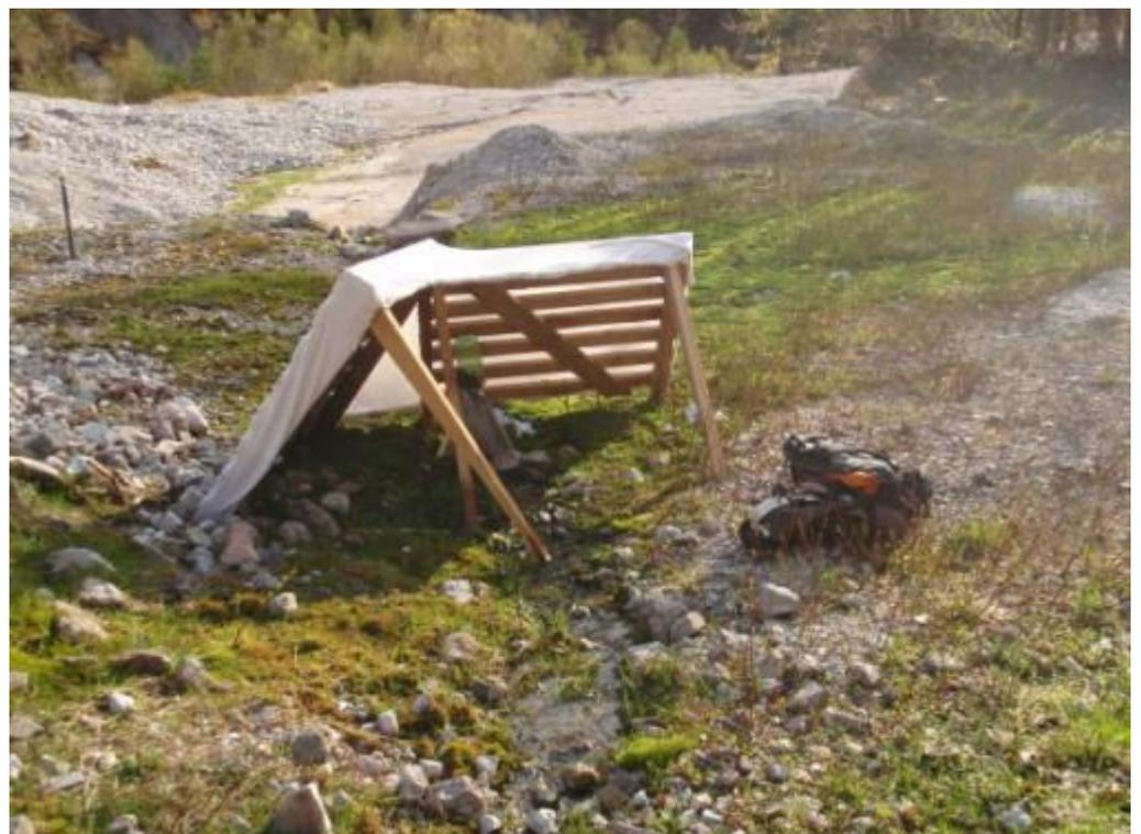
Bild 26: Bau des Sonnensegels am 13.4.2012. Es wurde notwendig, weil die Konservierungsflüssigkeit der Emergenzfalle durch die starke Einstrahlung verdunstete. - Fotos: H. Haseke
