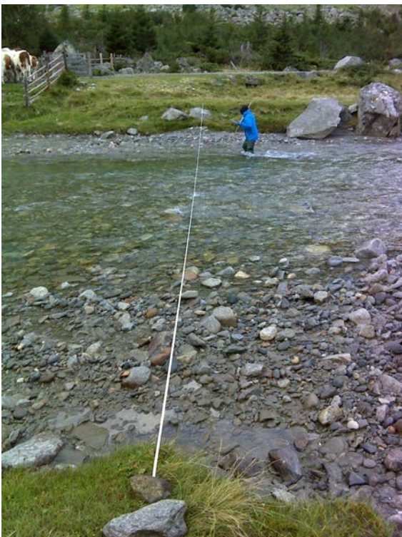
Abb. 31: Strömungs-Tiefen-Transektmessung zur Bestimmung des Abflusses
