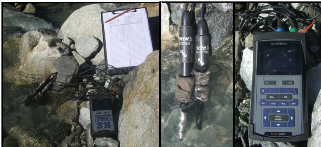
Abb. 43: WTW – MultiLine® 3430 mit pH-Elektrode (SenTix® 940), digitale Leitfähigkeitsmesszelle (TetraCon® 925) und optischer Sauerstoffsensor (FDO® 925)
