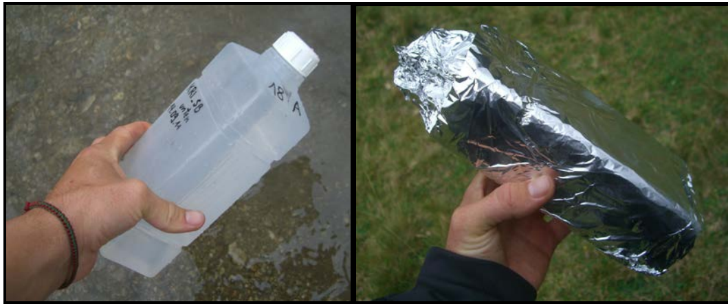
Abb. 44: Die Wasserproben sollten ohne längere Zwischenzeiten analysiert oder kühl gelagert werden.
