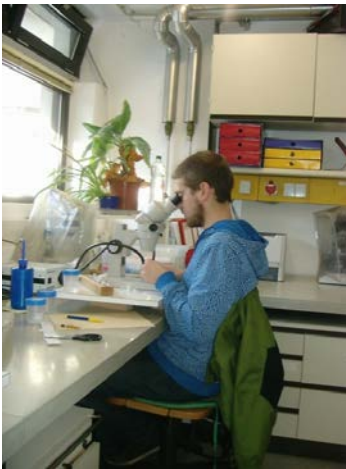
Abb. 48: Sortierung und Zählung der MZB-Proben unter der Stereolupe
