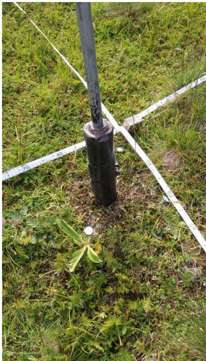
Abb.3-6: Auf der abgeernteten Fläche wurde eine Bodenprobe (∅ 5 cm) mittels modifiziertem O' Connor Splitcorer entnommen, je nach Profiltiefe in Vertikalfraktionen von 0-5, 5-10 und 10-15 cm Tiefe unterteilt, mit dem vereinbarten Standort Code beschriftet, gedeckelt und in einer Kühltasche verstaut.
