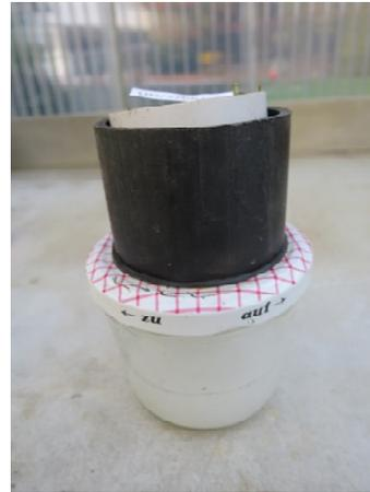
Abb.7-8: Modifizierter Macfadyen High Gradient Extraktor (links) mit Probeneinsatz und Auffanggefäß (rechts).
