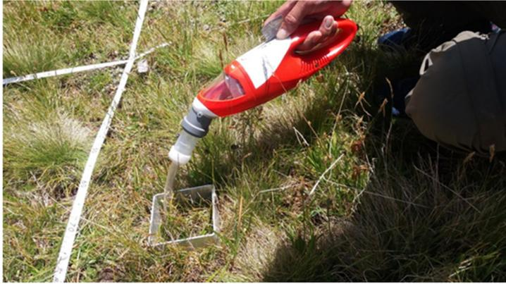
Abb.2: In einem ersten Arbeitsschritt wurden die epigäische Tiere der Mesofauna, auf einer durch einen Metallrahmen abgegrenzten Fläche von 10 x 10 cm, mittels eines eigens dafür adaptierten Akku-betriebenen Mini-Handstaubsaugers abgesaugt.
