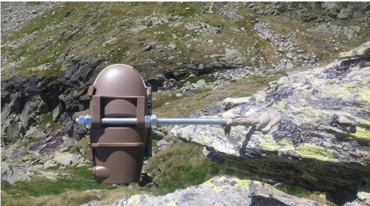
**Abbildung 12: Auf einer in den Stein geklebten Gewindestange befestigte Kamera. Ausrichtung und Fixierung der Kamera mit Sechskantmutter; Kamera S9**
