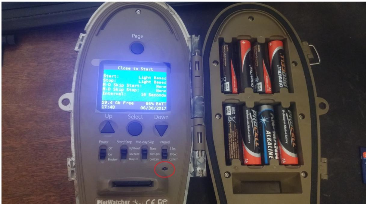
Abbildung 16: Taster (roter Kreis) zur Aktivierung des LCD-Displays für Einstellungen
