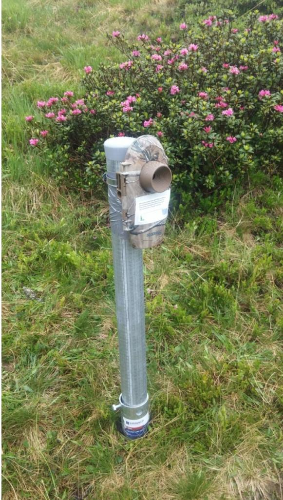
**Abbildung 10: Montierte Kamera mit Schlauchschelle auf Rundprofilstange, in grau gewellt dahinter befindet sich ein Gewebeklebeband gegen ein Verrutschen; Kamera I4**
