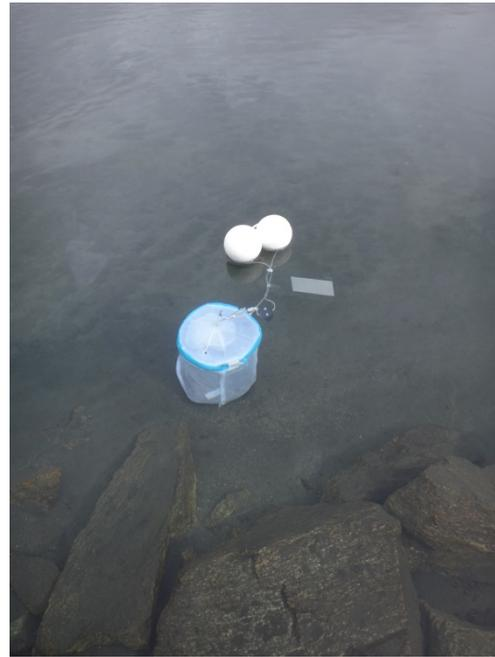
Abb. 4: Temperaturdatenlogger mit Styroporkugeln für Auftrieb und Sichtbarkeit und mit Steinen in Netzbehälter als Anker.
