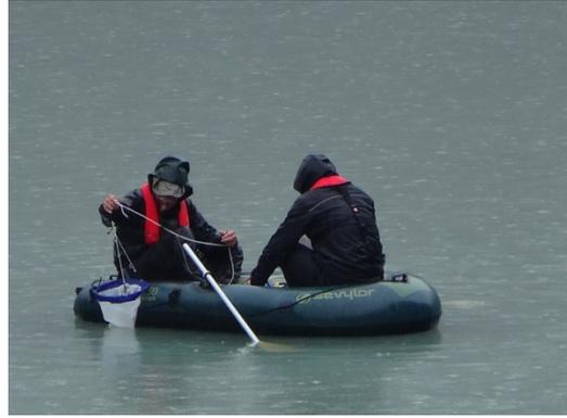
Abb. 2: Entnahme der Zooplanktonprobe mithilfe eines Planktonnetzes.
