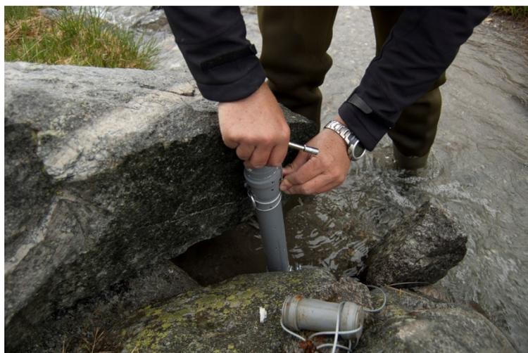
Abbildung 3. Projektleiter L. Füreder befestigt das wasserdurchlässige sogenannte Pegelrohr, in dem sich der Drucksensor befindet. Dieser zeichnet halbstündliche Druckänderungen auf und lässt Rückschlüsse auf die Höhe der darüberliegenden Wassersäule zu. Im Bild unten ist das Gehäuse des Temperaturdatenloggers zu sehen. Diese zeichnen, gleich wie auch die Drucksensoren, die Wassertemperatur im 30Minuten-Takt auf (Foto: B. Hechenblaickner, 07/2015).
