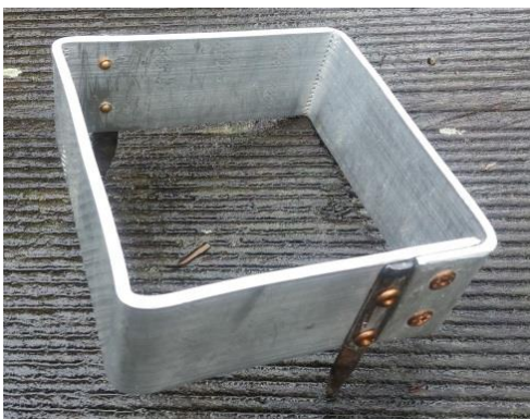
Abbildung 2: Metallrahmen zur Begrenzung der abzusaugenden Fläche
