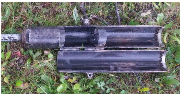
Abbildung 5: Bodenstecher aufgeklappt, eingeschweißter Begrenzungsring zur Aufnahme 3 Probenröhrchen
