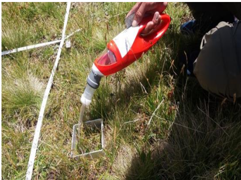
Abbildung 1: Mini-Handstaubsauger mit vorne aufgesetztem Sammelröhrchen und Saugschlauch
