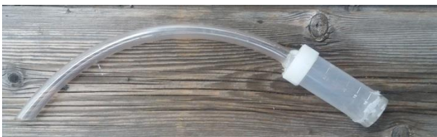
Abbildung 3: Sammelröhrchen mit Saugschlauch
