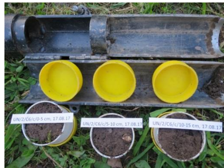
Abbildung 18 und 19: Eingestochener Bodenstecher, Bodenproben mit Beschriftungszettel und Verschlusskappen
