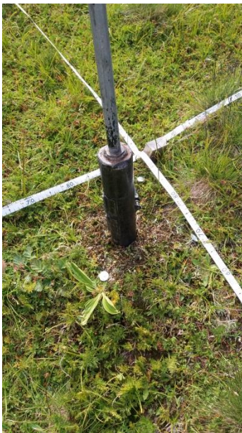
Abbildung 18 und 19: Eingestochener Bodenstecher, Bodenproben mit Beschriftungszettel und Verschlusskappen
