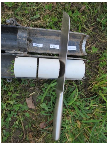
Abbildung 6: Aufgeklappter Bodenstecher mit ausgestochenem Bodenzylinder, Messer zur Durchtrennung der Tiefenfraktionen, Beschriftungszettel.
