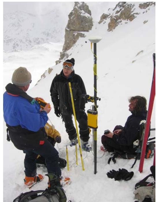
Abb. 20: Vergleich unterschiedlicher BTS-Sonden vor Beginn einer Messkampagne.
