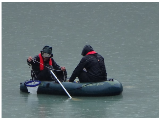
Abb. 3: Entnahme der Zooplanktonprobe mithilfe eines Planktonnetzes.
