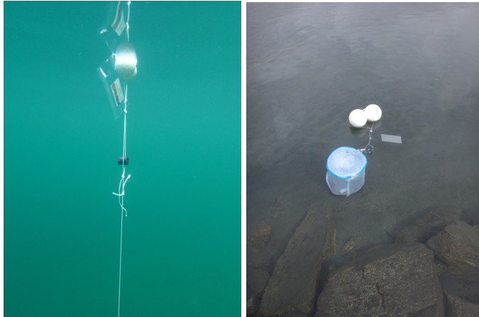
Abb. 2: Temperaturdatenlogger in wasserdichtem Gehäuse (schwarze Kapsel) in der Wassersäule hängend und im Blick auf die Wasseroberfläche. Oben sorgen 2 Styroporkugeln für Auftrieb und Sichtbarkeit an der Wasseroberfläche. Steine im Netzbehälter fungieren als Anker.
