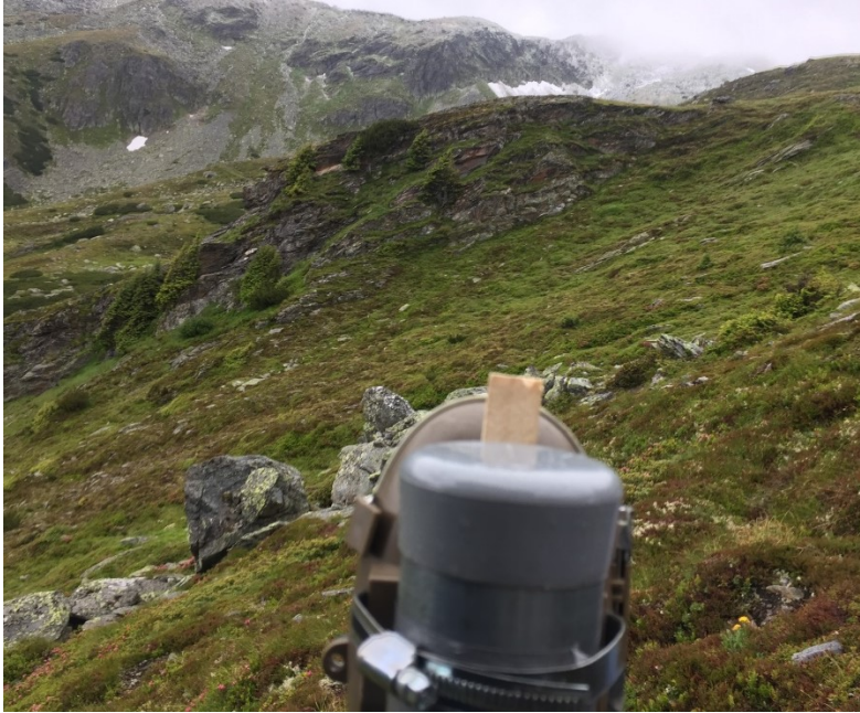
Abbildung 7: Ein Holzkeil wird zur Anpassung der vertikalen Ausrichtung zwischen Rundrohr und Kamera eingeschoben und selbst mit dem Gewebeband am Rundrohr gegen Verrutschen befestigt. Kamera SE4
