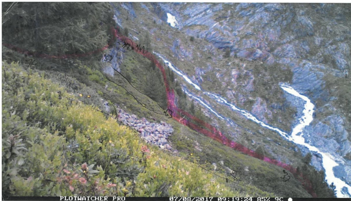
Abbildung 12: IN1, Messung der Entfernungen im Felde mit einem Entfernungsmesser (schwarzer Punkt mit Zahl in m), maximal einsehbarer Bereich = Monitoringfläche (Grenze rosa Linie).
