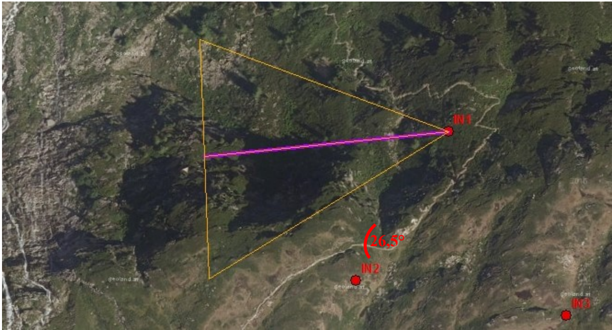
Abbildung 13: IN1, Beispiel zur Flächenberechnung. Die violette Linie symbolisiert den Kamera-Ausrichtungs-Winkel (Himmelsrichtung in 360 Graden, N=0°, W=270°) und maximale sichtbare Entfernung (m). Darauf basierend wurde das Sichtfeld der Kamera mit je 26,5° (halber Winkel des Kamerasichtfeldes) eingemessen (oranges Dreieck).
