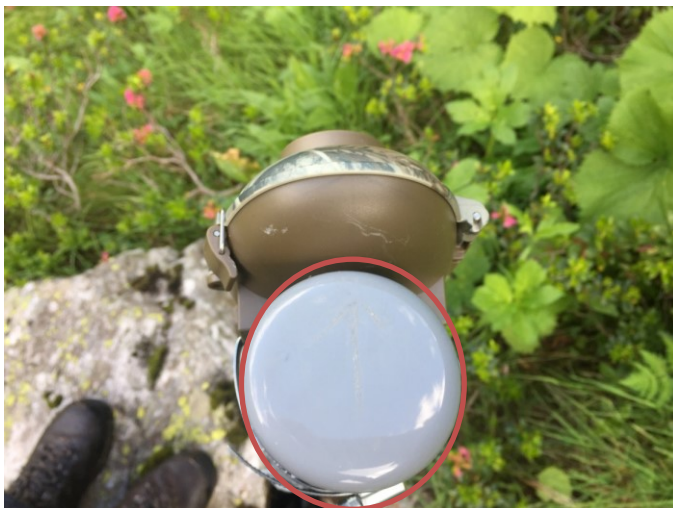
Abbildung 5: Pfeil an der Plastikkappe (mit rotem Kreis im Bild markiert; etwas schwer erkenntlich am Bild) zeigt die horizontale Ausrichtung für die Kamerainstallation an
