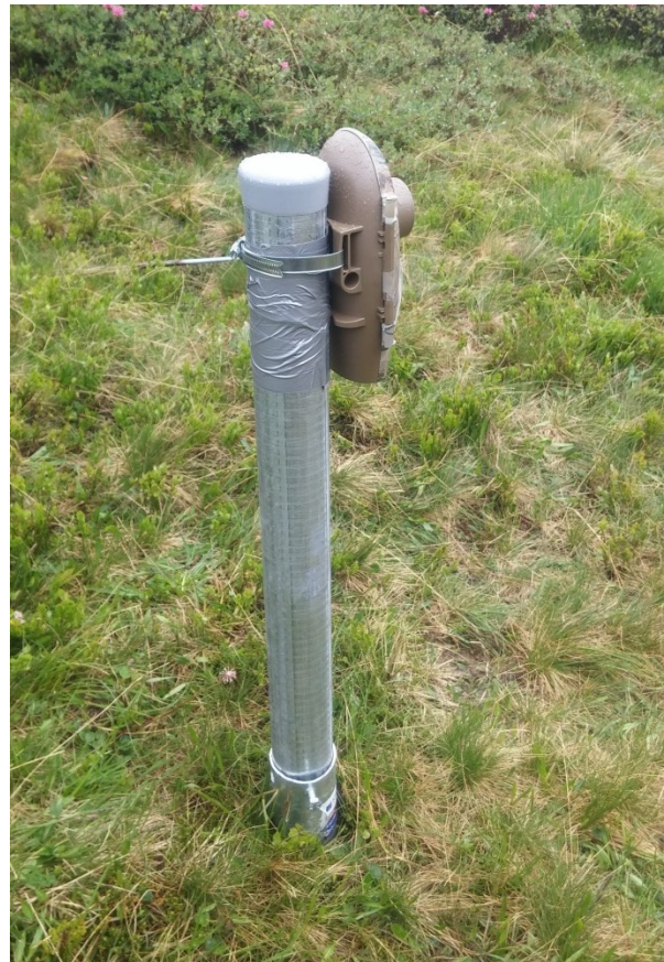
Abbildung 6: Montierte Kamera mit Schlauchschelle auf Rundprofilstange, in grau gewellt dahinter befindet sich ein Gewebeklebeband gegen ein Verrutschen; Kamera IN4
