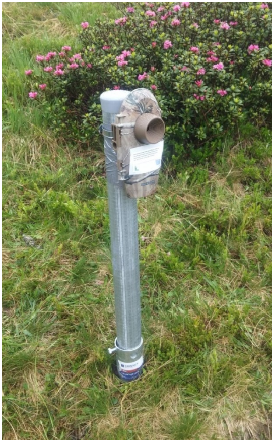
Abbildung 6: Montierte Kamera mit Schlauchschelle auf Rundprofilstange, in grau gewellt dahinter befindet sich ein Gewebeklebeband gegen ein Verrutschen; Kamera IN4
