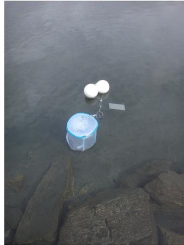
Abbildung 22: Temperaturdatenlogger (tempmate) mit Styroporkugeln für Auftrieb und Sichtbarkeit und mit Steinen in Netzbehälter als Anker.
