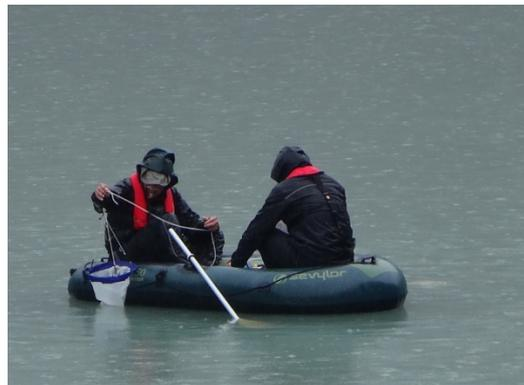
Abbildung 19: Schlauchboot mit Planktonnetz und Multisonde
