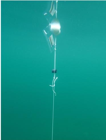
Abbildung 21: Temperaturdatenlogger (tempmate) in wasserdichtem Gehäuse (schwarze Kapsel) in der Wassersäule hängend. An der Wasseroberfläche sorgen zwei Styroporkugeln für Auftrieb und Sichtbarkeit.
