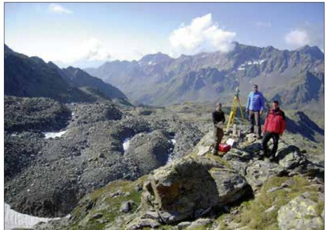
*Das klassische Blockgletschermonitoring mit Hilfe einer Totalstation wie hier am Weißenkar soll zukünftig durch eine satellitengestützte Positionsbestimmung ersetzt werden. Diese GNSS-Vermessungsmethode wird derzeit im Nationalpark erprobt.*
