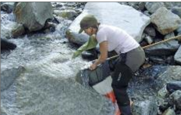
Probennahme im Feld mittels Surbersammler: der Sammler wird unter der definierten Probenstelle in die Strömung gehalten, um abdriftende Tiere aufzufangen. Anschließend wird auch die Steinfläche mit einer Stielbürste in den Sammler abgestreift (Foto: A. MÄTZLER).
