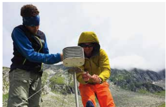
Errichtung einer Wetterstation nahe den Dauerflächen im Untersulzbachtal im ökologischen Langzeit-Monitoring
