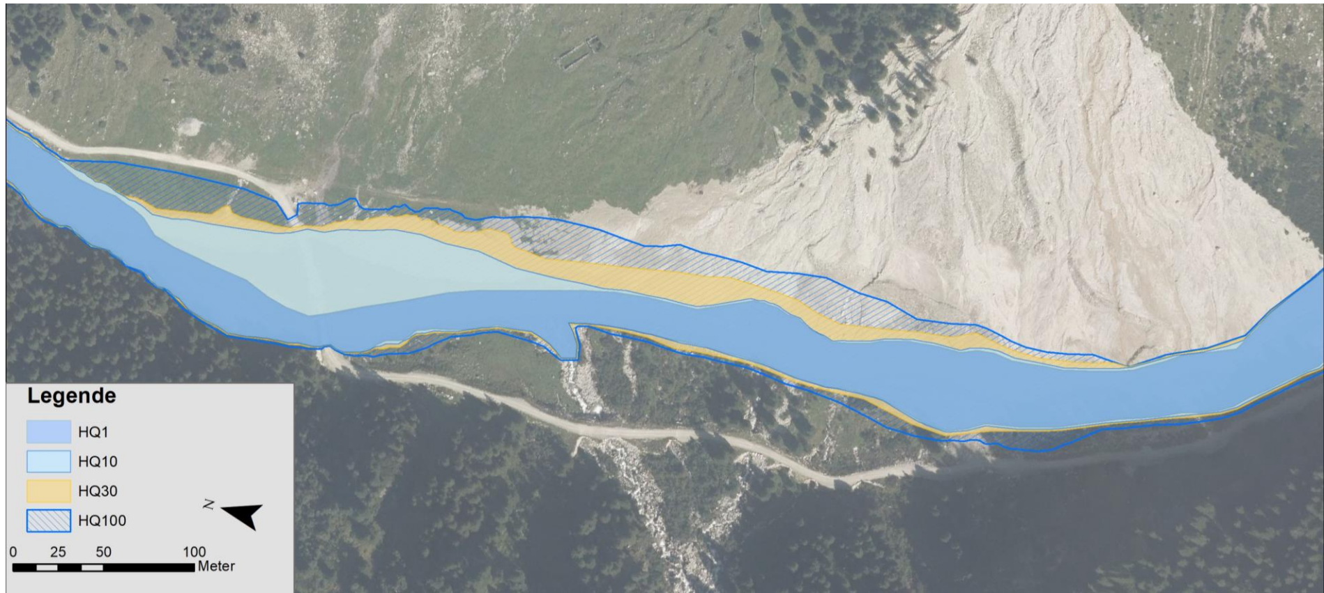
Abbildung 4-8: Überflutungsflächen aus hydrodynamischer 2D-Modellierung für den Bereich Sattelkar
