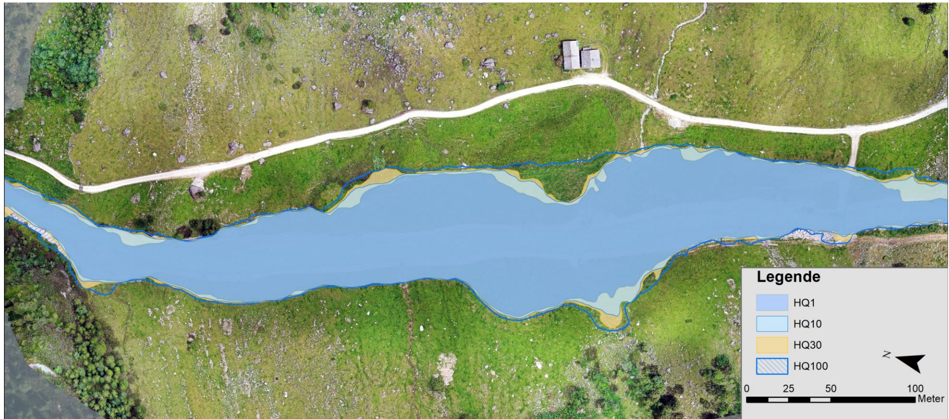
Abbildung 4-6: Überflutungsflächen aus hydrodynamischer 2D-Modellierung für den Bereich Foissenalm
