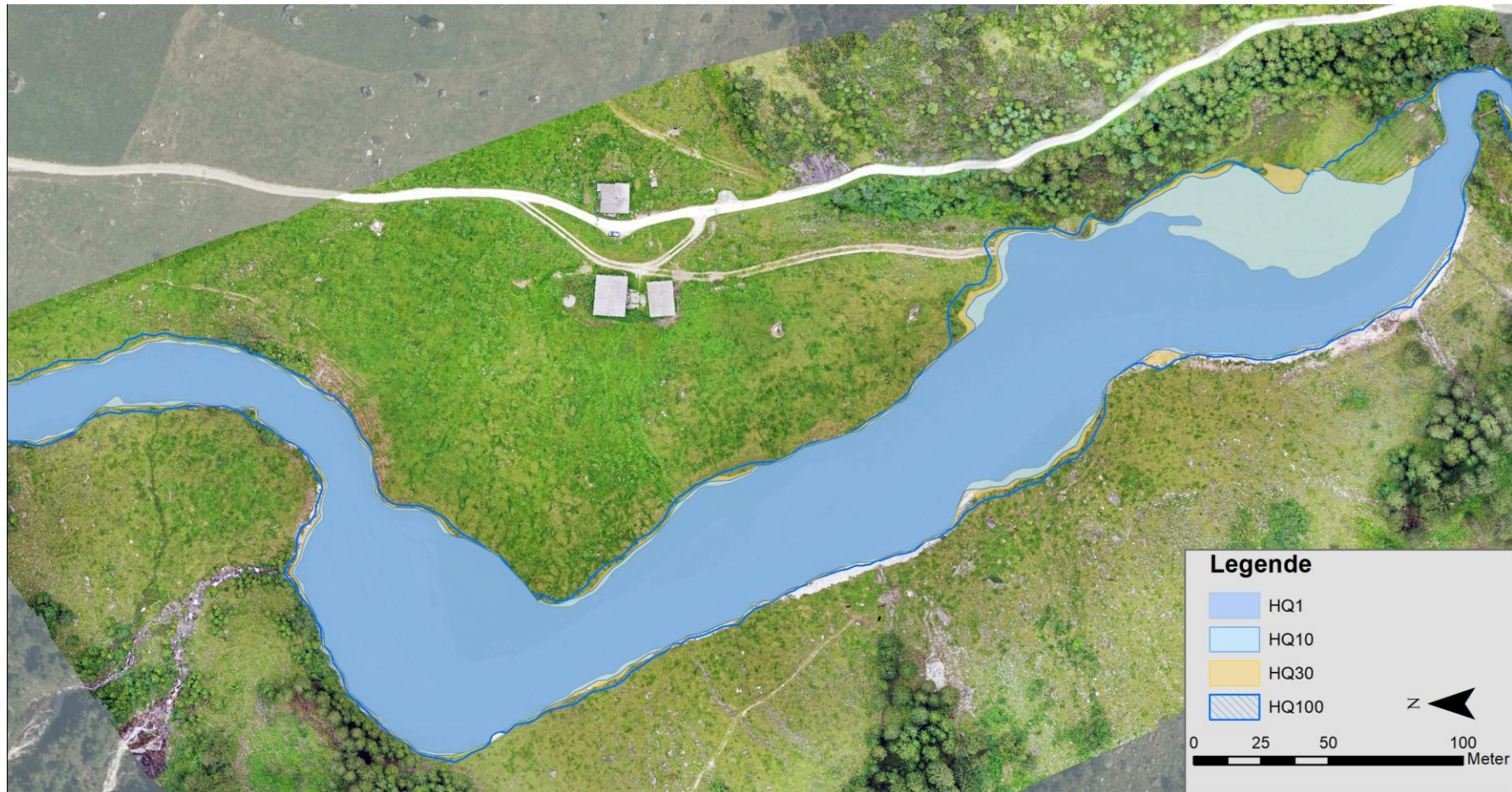
Abbildung 4-4: Überflutungsflächen aus hydrodynamischer 2D-Modellierung für den Bereich Poschalm
